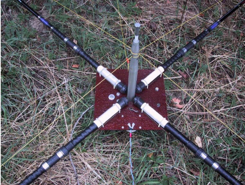
Obr. 3. Rybářské pruty a jejich upevnění k základové desce, včetně chráničů prutů a strunových závěsů eliminujících prohnutí prutů.
