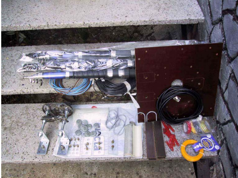
Obr. 2. Vybavení materiálem na zkoušení drátovky. Ve výbavě nechybí 4 rybářské pruty, velké knoflíky na izolátory a spojovací prvky z dětské stavebnice MARS.
