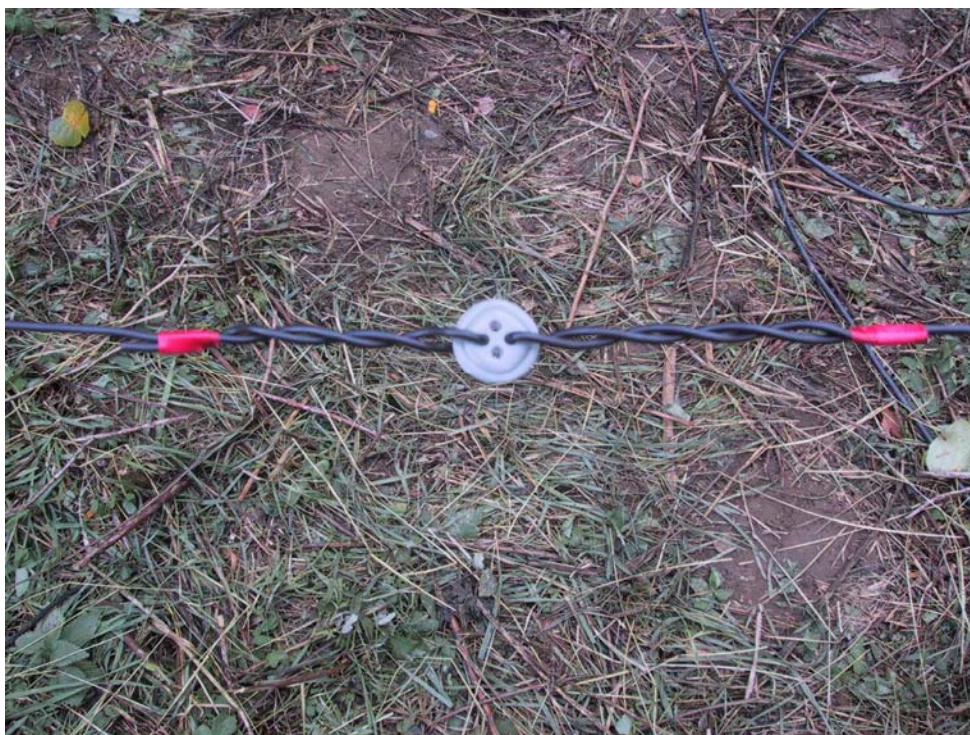
Obr. 8. Uchycení konců prvků k izolátoru – knoflíku v konfiguraci vhodné pro ladění antény, pro rychlou změnu délky prvků.
